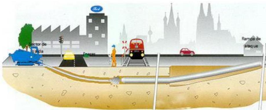
La etapa constructiva se puede describir de la siguiente manera: una vez instalada la máquina para que el cabezal de perforación se introduzca en el suelo, se procede a la ejecución de la perforación guía o piloto, para luego realizar la ampliación del diámetro de la perforación piloto, utilizando los expansores (escariadores) adecuados, para luego colocar la tubería en el interior de la perforación.
