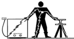
Se entiende como masa conductora (generalmente metálica) a todo elemento conductor que no configura una parte activa de la instalación y que es eléctricamente energizada por una falla de la aislación o contacto con una parte activa (gabinetes metálicos de tableros, heladeras, carcasa de motores o herramientas eléctricas, etc.)
